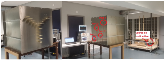
Figure 6. Banc de mesure expérimentale. (a) 16 antennes connectées à la face avant de la cavité. (b) 4 voies de sortie.
