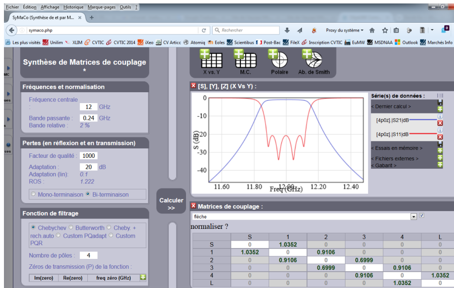
Fig.4. Logiciel en ligne (intranet) de synthèse de filtre par matrice de couplage (9).
