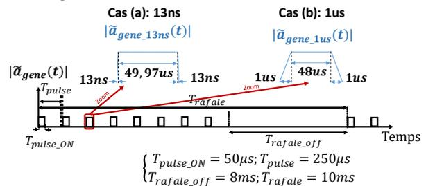
Figure 1. Définition des enveloppes des 2 trains d'impulsions.
