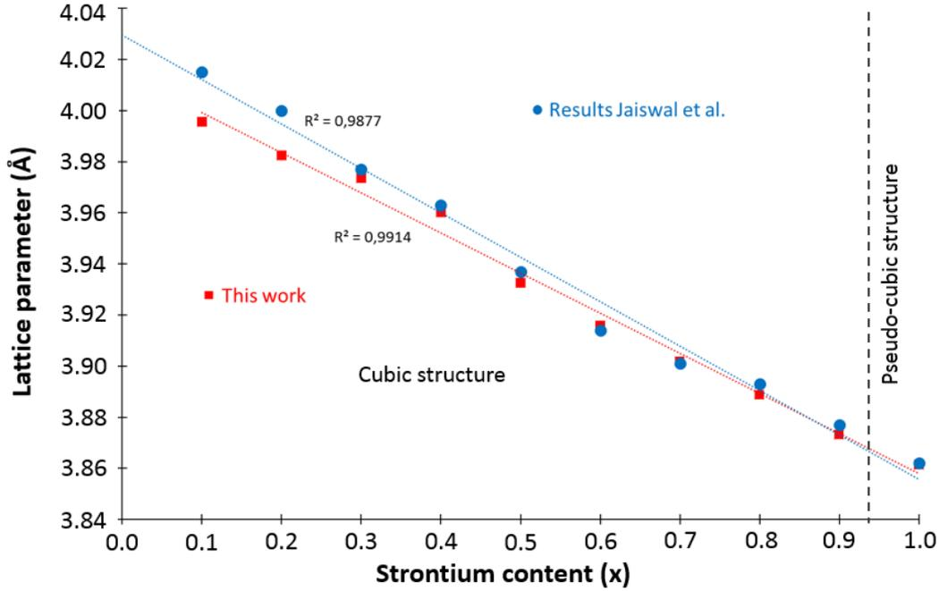
Fig. 3: Lattice parameter values of BSF perovskite materials
