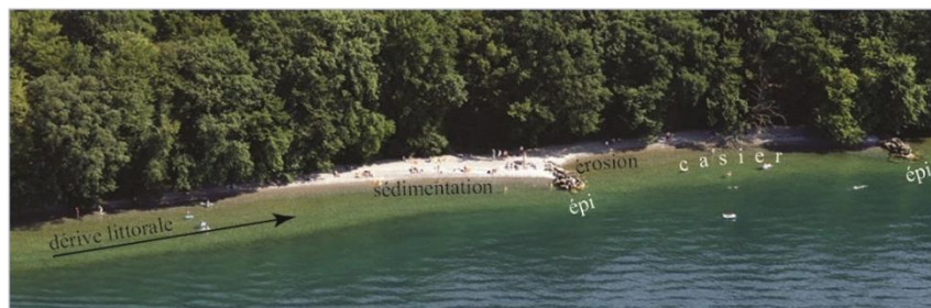
Photo 6 (été 2004, cliché de la CIPEL) : Si le dépôt de sédiments agrandit la plage située en amont de l'épi, celle située en aval, privée de la majeure partie des sédiments, démaigrit.
