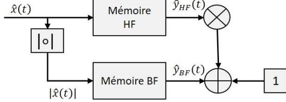
**Figure 1. Topologie simplifiée du modèle TPM**
