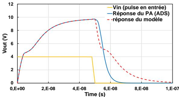
Figure 4 : Comparaison entre les tensions de sortie obtenue par simulation « circuit » sous ADS et par calcul de réponse impulsionnelle (Matlab)
