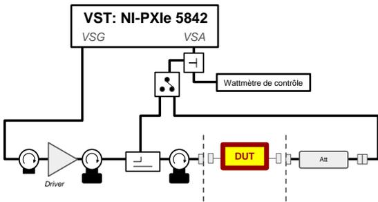
Figure 5 : Schéma du banc de mesure basé sur le VST
