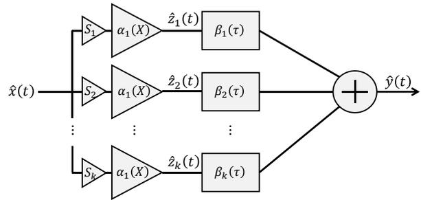
Figure 6 : Topologie du modèle après SVD
