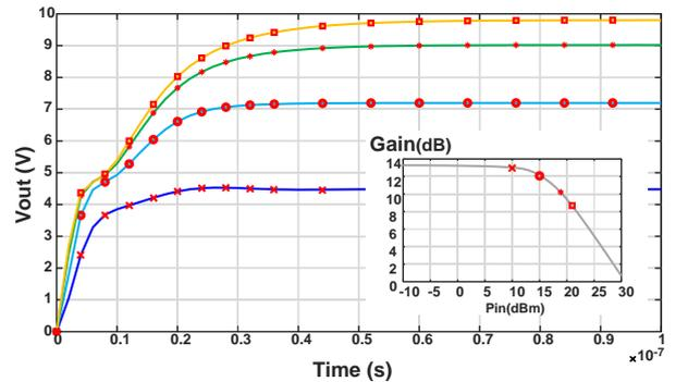
**Figure 3 : Comparaison des tensions de sortie entre la simulation ADS et le modèle NIR (Matlab) pour plusieurs niveaux d'impulsion en entrée de PA**
