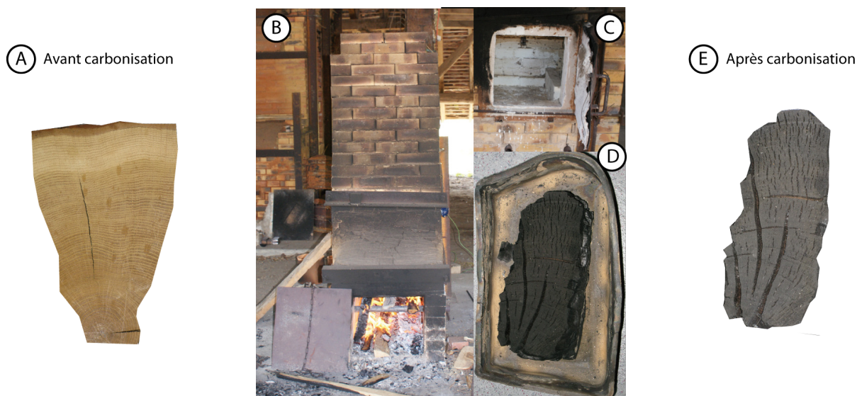
Figure 63 : Carbonisation des rondelles de bois dans un four de potier aux tuileries de Pouligny. (A) Section de bois. (B) four de potier chauffé au bois. (C) Foyer dans lequel sont placées les sections de bois. (D) Boîte contenant les sections de bois. (E) Section de bois carbonisée
